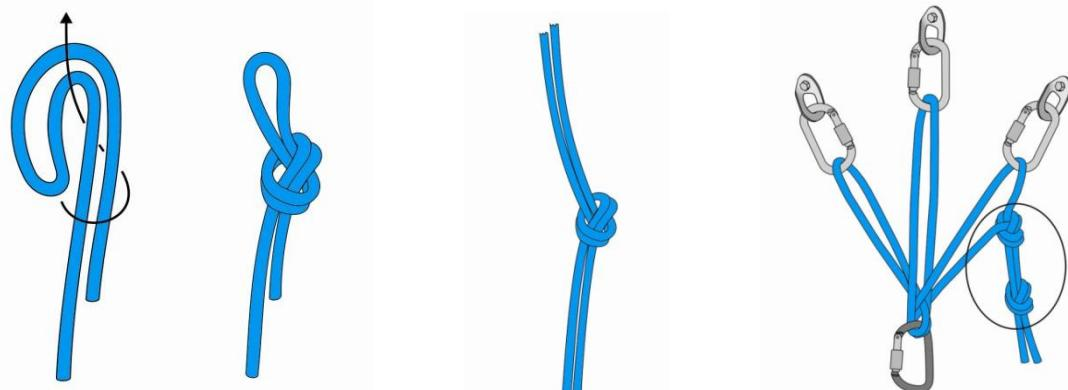
Vezanje šestice slika 1, spajanje dva kraja užeta, npr. za spuštanje niz uže slika 2 te spajanje sidrišnog užeta na samopodesivom sidrištu uzom šestica slika 3. (crtež: Darko Bakšić)
